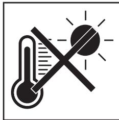
**ITA.** Alte temperature ambientali provocate da condizioni climatiche estreme o da altre fonti di calore riducono la durata e l'efficienza della componentistica o del modulo LED.
