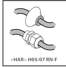
**ITA.** Utilizzare un cavo di alimentazione con tipologia idonea (cavi flessibili HAR H05/07 RN-F o idonei per l'utilizzo all'esterno); i cavi rigidi possono compromettere la tenuta attraverso il pressacavo/passacavo.
