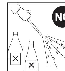
**ITA.** Nessuna parte dell'apparecchio, deve stare a contatto diretto con sostanze chimiche aggressive (es. fertilizzanti, diserbanti, calce).
